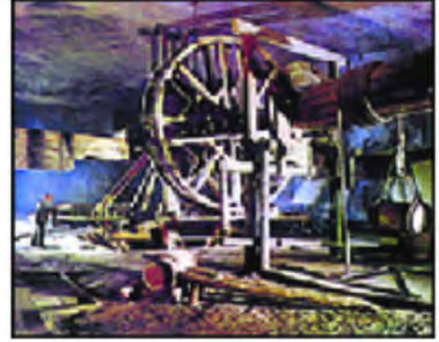
(٢٢١) هنا دولاب خشبي مسنن أفقياً، وآخر عمودي كبيرين جداً استخدماً في أحد المناجم الأوربية القرن (١٨م).
